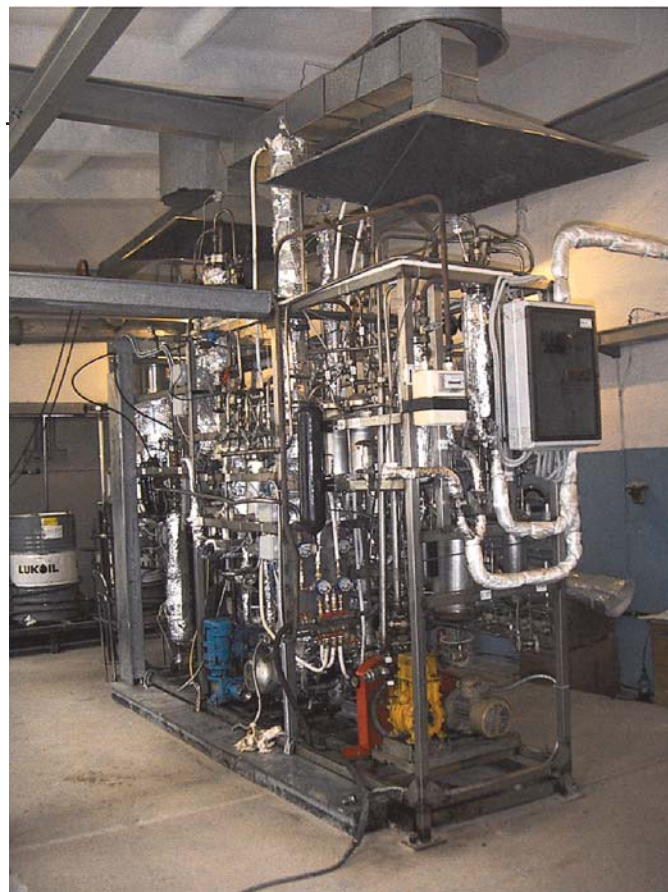
Рис. 7. Экспериментальный технологический модуль по переработке нефти
