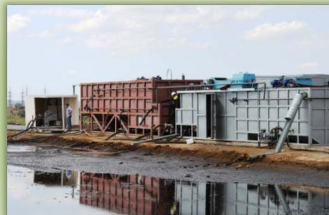
**Мобильное исполнение:** Каждый модуль установки может быть укомплектован полуприцепом соответствующей грузоподъемностью для транспортировки по автомобильным дорогам общего пользования, а вся установка при этом может быть укомплектована оборудованием для спуска части модулей с транспортного средства на период эксплуатации.
